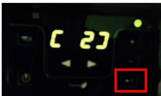
Le sous menu [2] permet de paramétrer la luminosité du display en mode veille. Appuyer sur + ou – pour la régler de 1 à 5 ou sur OFF si vous voulez désactiver cette fonction.
